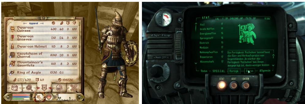
Abbildung 3.3: Die GUI zweier Spiele („Oblivion“ und „Fallout 3“) im Vergleich: Sie ist jeweils an das Szenario des Spieles angepasst. Standardkomponenten des Betriebssystems werden nicht verwendet.
